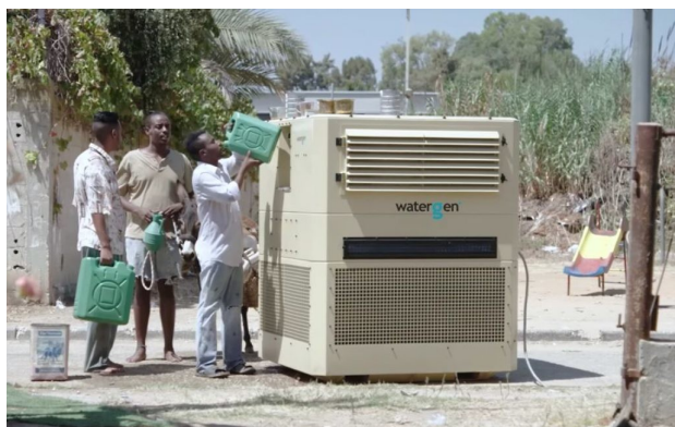
Máy chế tạo nước từ không khí của Water-Gen [Ảnh: The Times of Israel]
