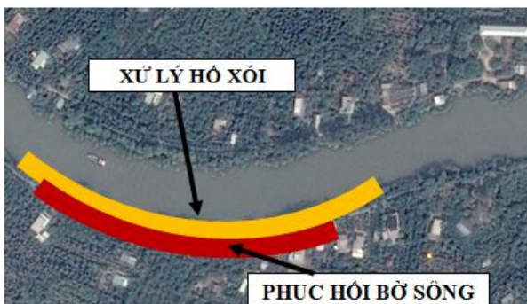
Hình 14. Xử lý hố xói sâu trước khi phục hồi bờ sông bị sạt lở
