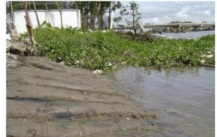
Hình 9. Kết cấu thảm cát (trái) và thử nghiệm trên sông Sài gòn năm 2002 (phải)
