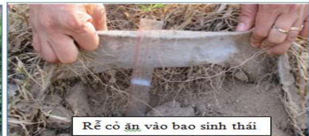
Hình 10. Quá trình thử nghiệm bao cát sinh thái
