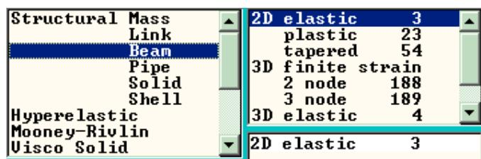
Đối với đối tượng là dầm, cần chọn phần tử dầm. Chọn phần tử Beam cho phép tính toán dầm có diện tích tiết diện và chịu uốn. Cần nhập đủ các đặc trưng hình học của mặt cắt. Phần tử BEAM giải cho các dầm đàn hồi, dầm dẻo, các phần tử 3D biến dạng hữu hạn, phần tử 3D 2 nút hoặc 3 nút.
