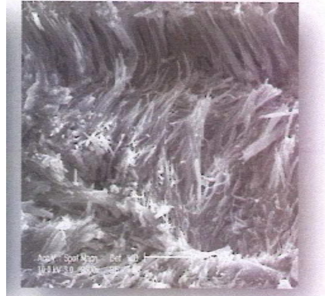
Phản ứng nước – xi măng – Rovo Tạo thành liên kết dạng sợi, tăng tính bền và dẻo
