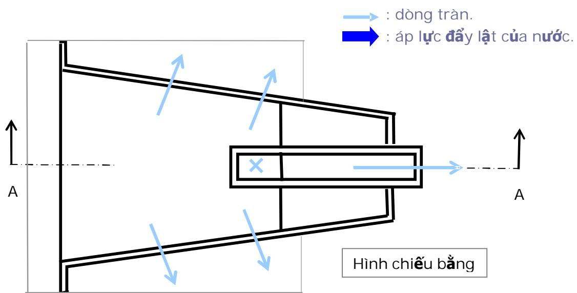
**V**ật liệu có thể là kim loại hoặc các loại vật liệu xây dựng tương đối nhẹ, đủ nhạy cảm khi xuất hiện áp lực nước đầy lật. Những kích thước trên hình vẽ đều mang tính ước lệ. Khi thiết kế cần tính toán chi tiết và kiểm nghiệm trên mô hình vật lý. Cũng có thể cải tiến thêm, thậm chí cải tiến để sử dụng thường xuyên như một dạng cửa van tự động.
