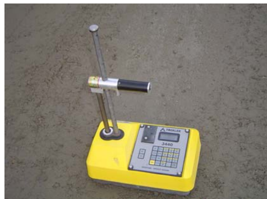
Hình 1. Xi lô trộn cấp phối vữa BTĐL và thí nghiệm kiểm tra độ đầm chặt
