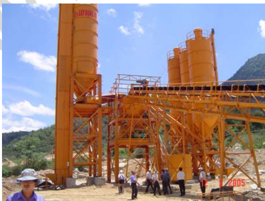
Hình 1. Xi lô trộn cấp phối vữa BTĐL và thí nghiệm kiểm tra độ đầm chặt
