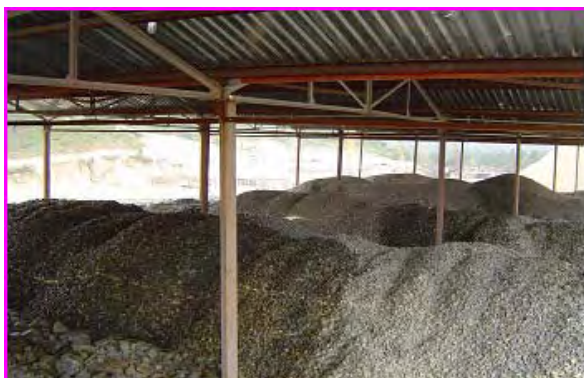
Hình 4: Đá dăm được che mát, tưới ẩm để hạ nhiệt
