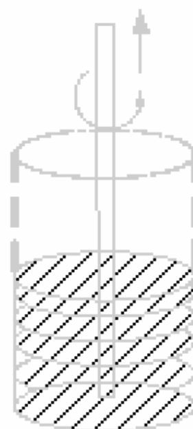
Khoan phụt cao áp Jet grouting
