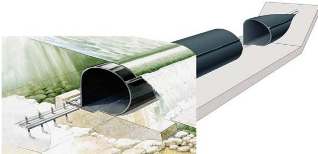
Hình dạng & cấu tạo đập cao su.
