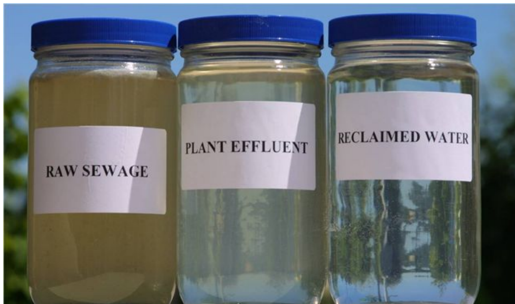
Nước thải, nước thải đã thanh lọc và nước tái chế. [Ảnh: Internet]
