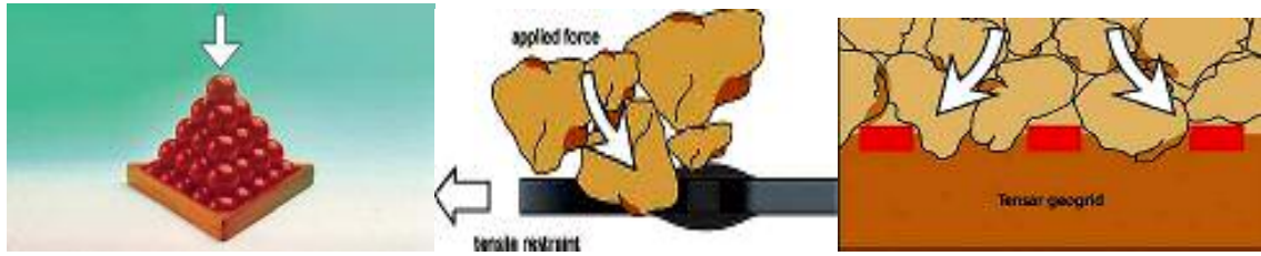
Hình 1: Hình dạng mặt cắt ngang tiêu biểu của cạnh lưới Tensar tạo nên các điểm tựa chịu lực cho các hạt vật liệu và hoạt động như chiếc giá đỡ khối bóng bi da hình tháp
