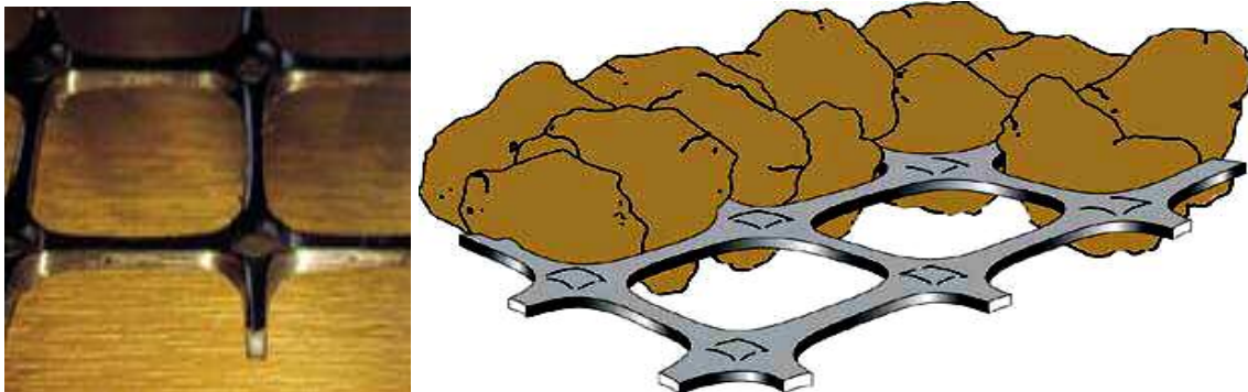
Hình 6: Hình dạng kết cấu lưới địa kỹ thuật Tensar
