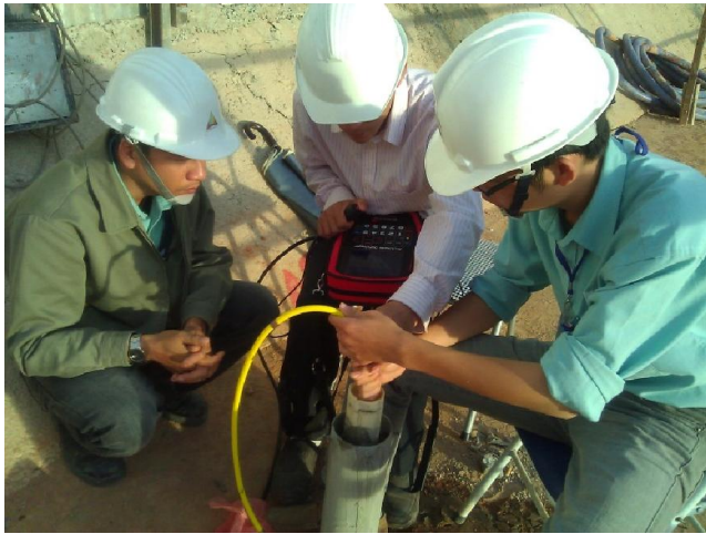
Quan trắc chuyển vị ngang bằng Inclinometer
